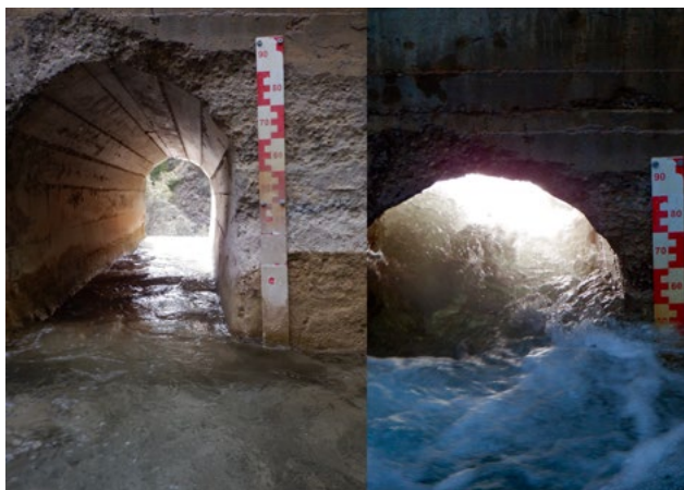
Regla limnimétrica para el control de aforo. / Fuente: Miguel María Delgado Boldú.
